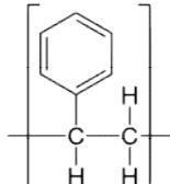
Полистирол ( – CH<sub>2</sub>-CH(C<sub>6</sub>H<sub>5</sub>)-CH<sub>2</sub>- )<sub>n</sub> – стиролдың (винилбензол) полимерленуі нәтижесінде түзілген өнім. Қатты, түссіз, шыны тәрізді, серпімді зат. Температурасын 80-150 °С дейін қыздырса, ол каучук тәрізді материалға айналады, ал 250-300 °С стирол түзе айрылады.
