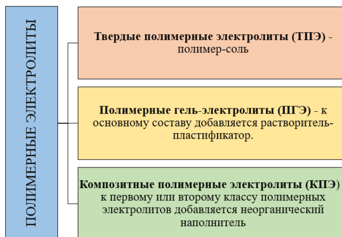
Рисунок 2 - Основные классы полимерных электролитов [5].
