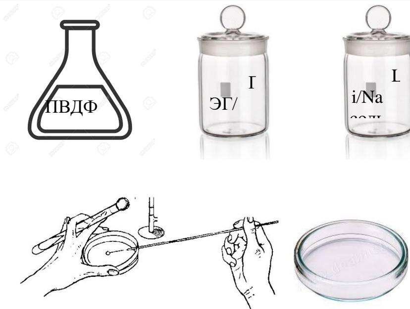
Рисунок 4 – Схема получения композитных пленок
