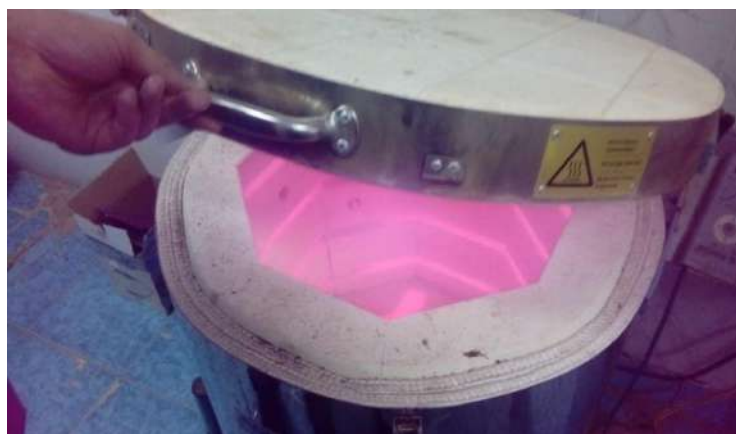
Рисунок 2 – Оборудование в виде мини-печи для технологии фьюзинг
