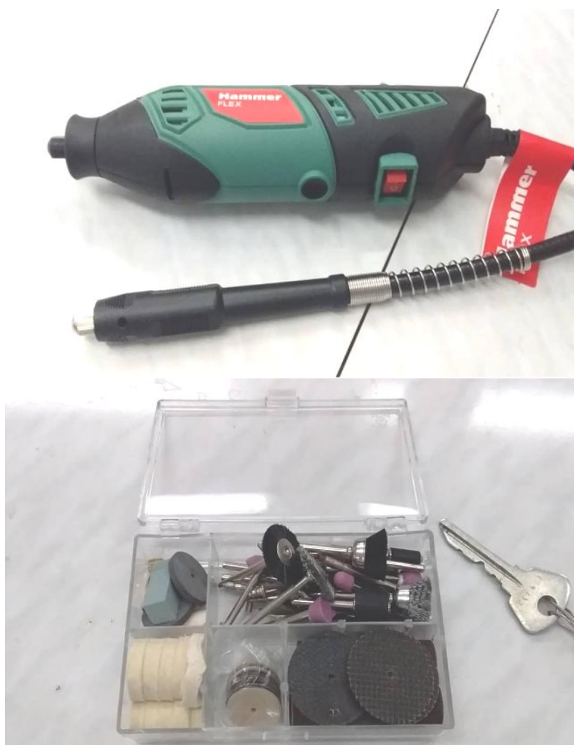
Сурет 3 – Гравировка жасауға арналған ротациялық құрылғы Hammerflex MD170A 113–003 (Чехия)
